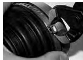
Schritt 4 Klemme über Objekt positionieren. Verschluss in kleinstmögliche Position einhängen. Klemmenohr mit Oetiker Zange richtig schliessen.
