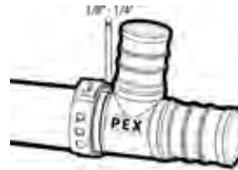
Die empfohlene Entfernung (Mass) zwischen der „Klemme“ und dem „Rohrende“ beträgt 1/8"-1/4".
