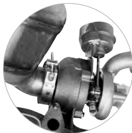
Automobil: Verbindung Turbolader – Katalysator
